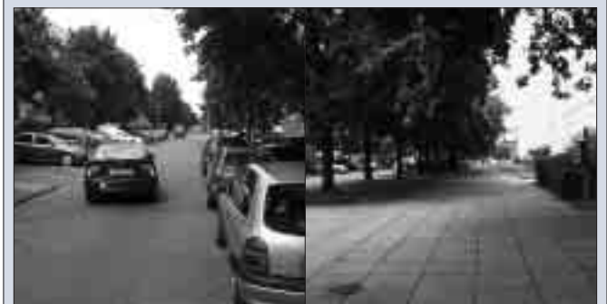
Rigaer Straße zwischen Alsdorfer und Hradeker Straße: Die Analyse des ruhenden Verkehrs ergab, dass vor allem in diesem Abschnitt ein erhöhter Bedarf an wohnungsnahen Parkplätzen besteht. Darum ist auf der östlichen Straßenseite eine Erweiterung und Neuordnung der Stellplätze vorgesehen. Durch eine Verminderung der Tiefe der bestehenden Parkplätze von 5,50 auf 4,50 Meter soll der Anteil der Grünflächen deutlich erhöht werden. Im Zuge der Neuordnung werden die Straßenbäume durch Neupflanzungen (Baumhasel) ersetzt. Die Gehwegbreite wird analog zur westlichen Straßenseite auf drei Meter reduziert. In den Kreuzungsbereichen werden die Bordsteine abgesenkt.
