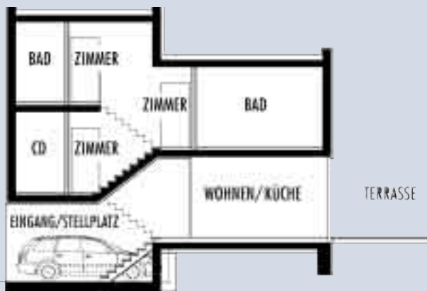
Grundrissvariante für ein Reihemittelhaus: 4-Zimmer-Wohnung mit 85,6 m² Wohnfläche, Terrasse im Erdgeschoss, 1 Pkw-Einstellplatz
